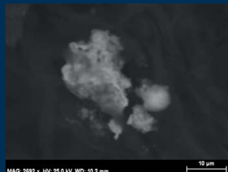
Zdjęcie z mikroskopu optycznego (wyposażonego w kamerę cyfrową) powierzchni liścia sałaty poddanej ekspozycji na cząstki pyłu oraz dwa obrazy tej powierzchni wykonane za pomocą skaningowego mikroskopu elektronowego (fot. ze zbiorów LASIR)
